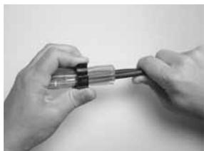
② 套入端套并夹上固夹
